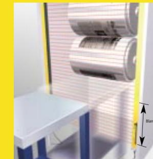
Se viene utilizzata la funzione di blanking fisso, questa viene annullata in caso di rimozione del piano di lavoro. Se viene rilevato l'accesso di una mano all'area pericolosa, le uscite della barriera disattivano gli organi di comando, ponendo la macchina in sicurezza.
