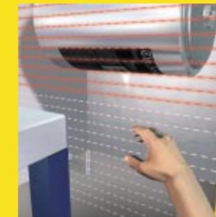
Per mantenere un adeguato livello di sicurezza bisogna posizionare le barriere in modo che l'operatore, anche una volta rimosso il piano di lavoro, non possa venire a contatto con parti pericolose della macchina. Per ovviare a questo inconveniente si può ricorrere all'utilizzo della funzione di blanking fisso.
